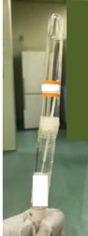
スピッツ管を 連結して代用
