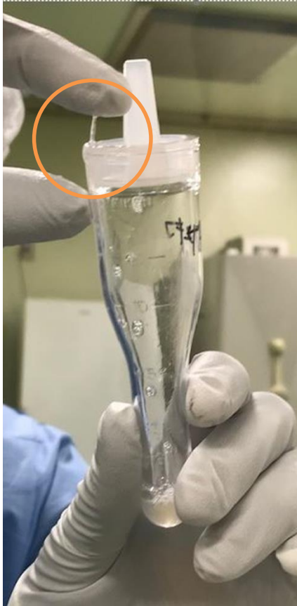
フタがきちんとされていない (写真は漏れ事例)
