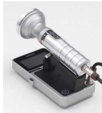
プラスチックシンチレーションサーベイメータ ( \beta 線用)
