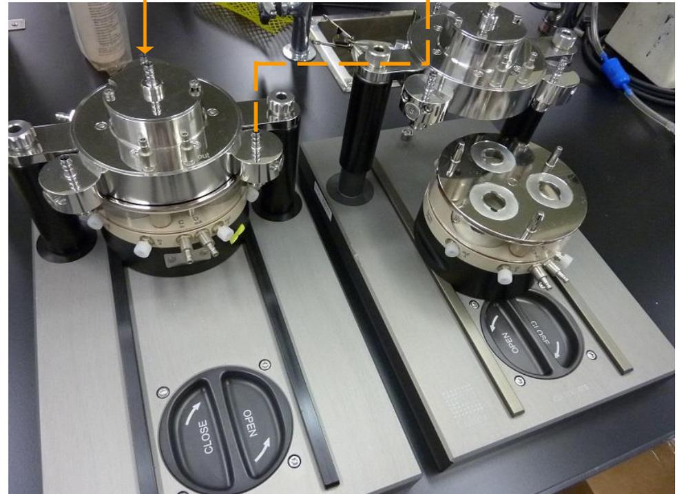
培養細胞ばく露装置 Cultex® RFS
