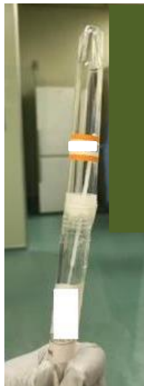
スピッツ管を 連結して代用
