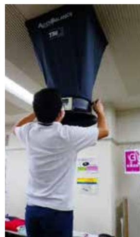
写真1 風量の測定風景
